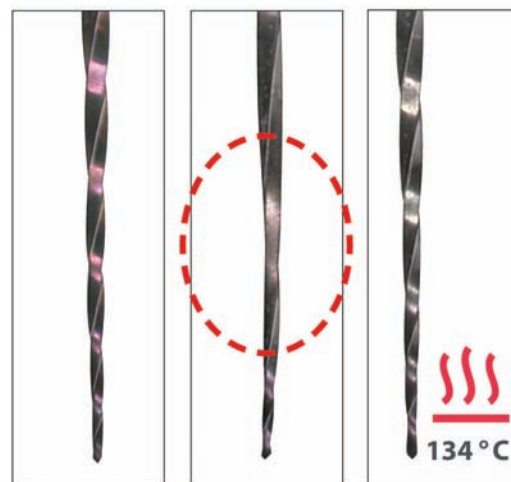
Abbildung 9: Durch Erwärmung auf 134 °C erlangt die Feile wieder ihre ursprüngliche Form. Sogar eine Verlängerung der Spiralstruktur lässt sich häufig wieder rückgängig machen.
